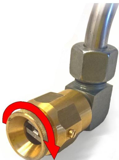
Vrid ringen på Retermia-specialmunstycket till högtrycksläge
